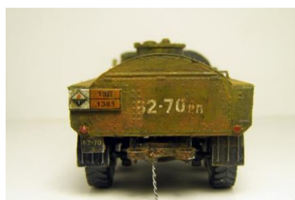
Заземление с помощью металлической цепи
